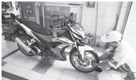
DAM 001 : Seorang Mekanik sepeda motor Honda sedang melakukan pengecekan tekanan angin ban pada motor Konsumen.
