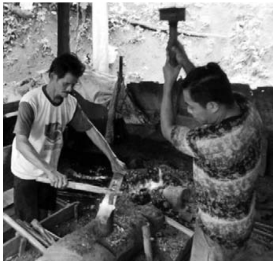
MEMBUAT: Para pengrajin di Kampung Dokdag tengah membuat alat pertanian dari besi turun temurun.
