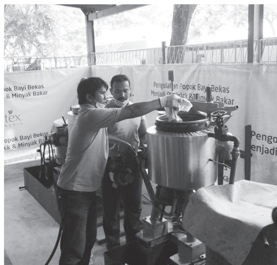
COBA MESIN: Petugas dari Guna Olah Limbah (GOL) tampak sedang memerhatikan penggunaan mesin hidrotermal yang dapat mengolah popok bekas pakai menjadi pokbrick dan minyak bakar.
